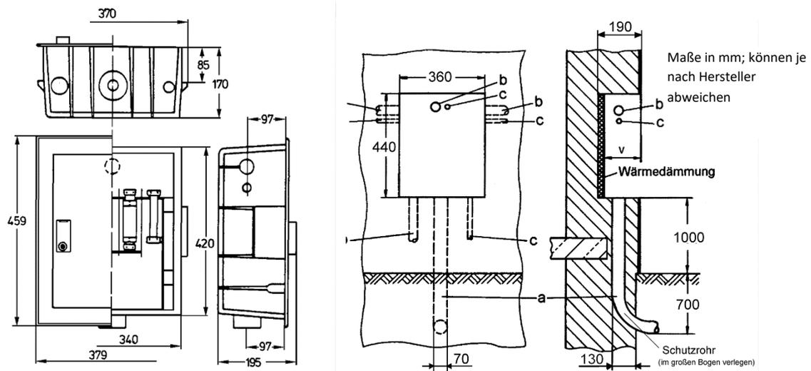
Abbildung 2: Außenwand-Hausanschlusskasten
