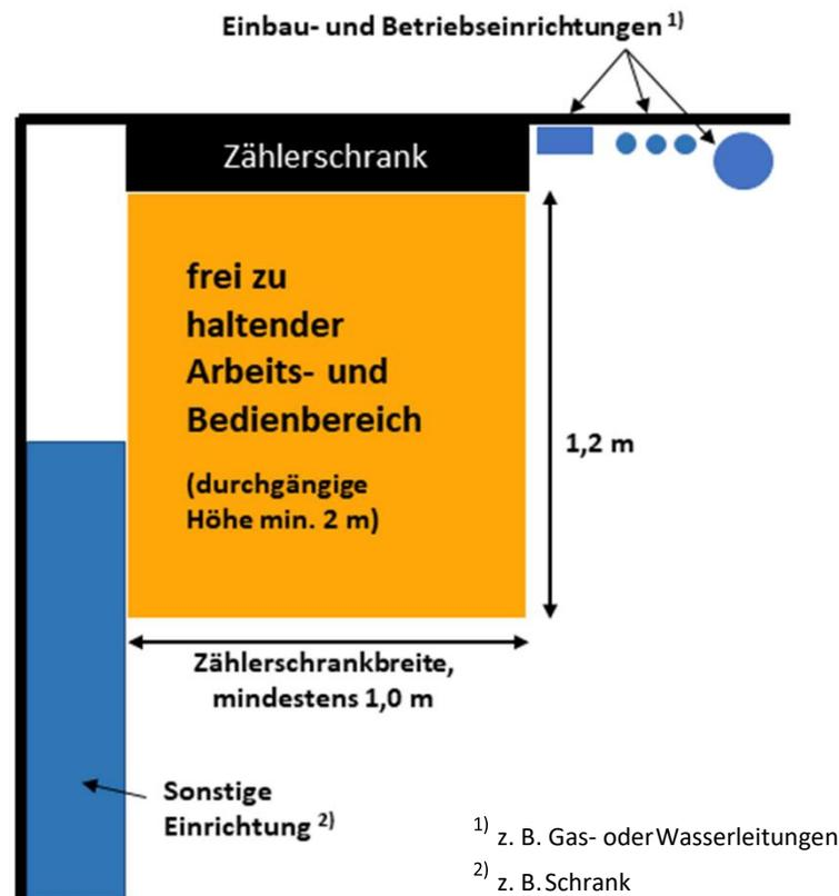
Abbildung 4: Arbeits- und Bedienbereich vor dem Zählerschrank
