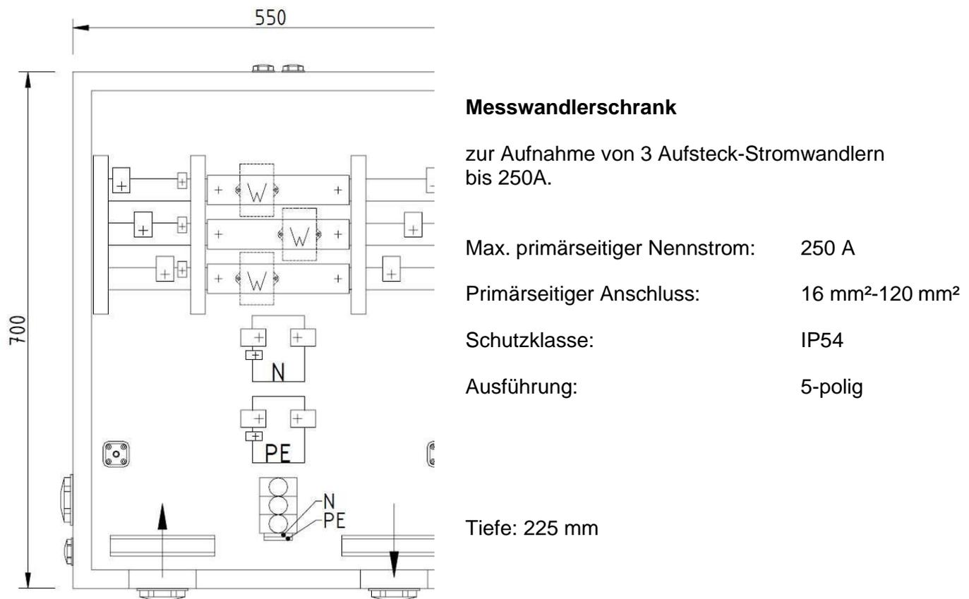
Abbildung 7: Messwandlerschrank zur Aufnahme von 3 Aufsteck-Stromwandlern bis 250A
