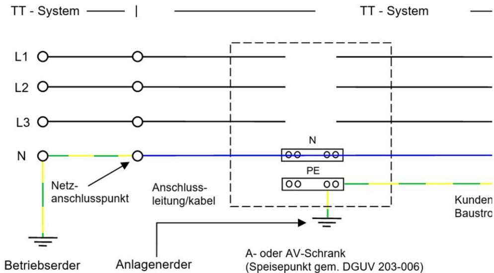
Abbildung: Anschlussmöglichkeiten am Beispiel des TT-Systems
