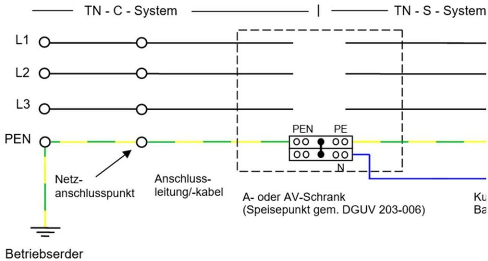
Abbildung 10: Anschlussmöglichkeiten am Beispiel des TN-C-Systems
